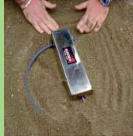
Kurulum faaliyetleri sırasında DSM ölçüm cihazı-Itwad Barajı, Suudi Arabistan
